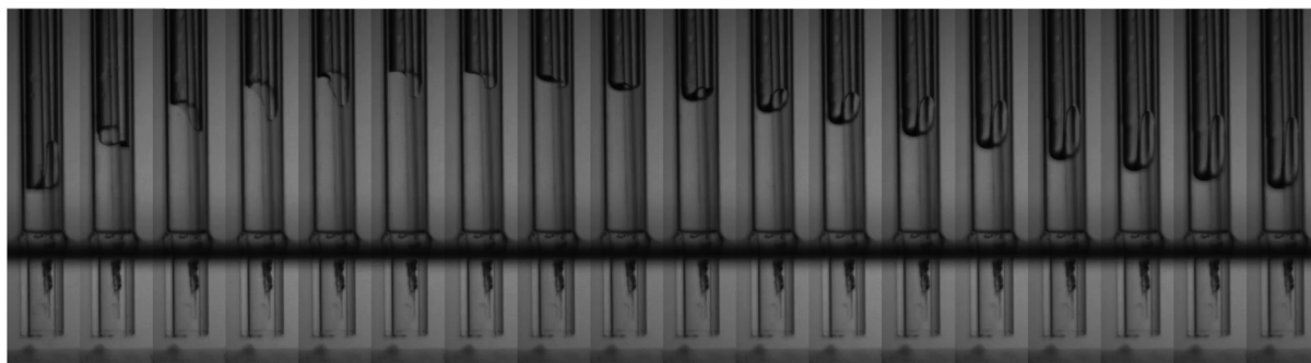
Рис. 2. Динамика подъема и опускания уровня воды в трубке после схлопывания парового пузырька. Время между кадрами – 10 мс
